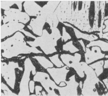
Abb. 1. Korrosion an Phasengrenzen
